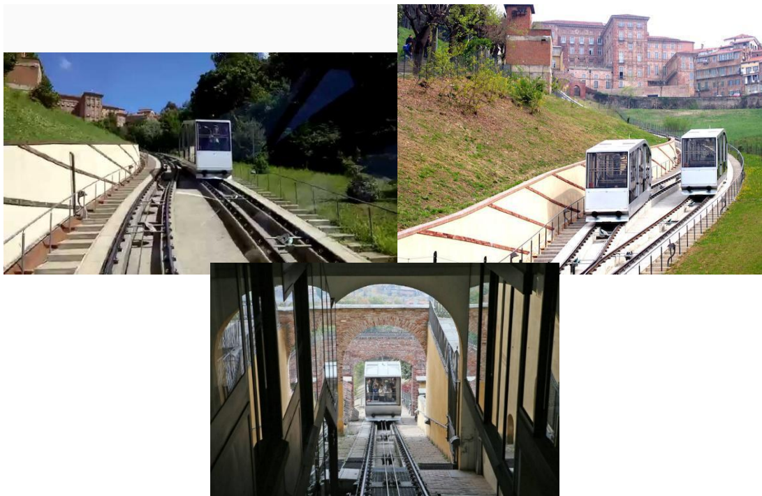
Figura 23 –Dettaglio vetture e via di corsa della funicolare
